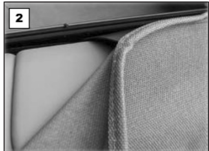
Glisser la languette entre la vitre et le joint d'étanchéité.
