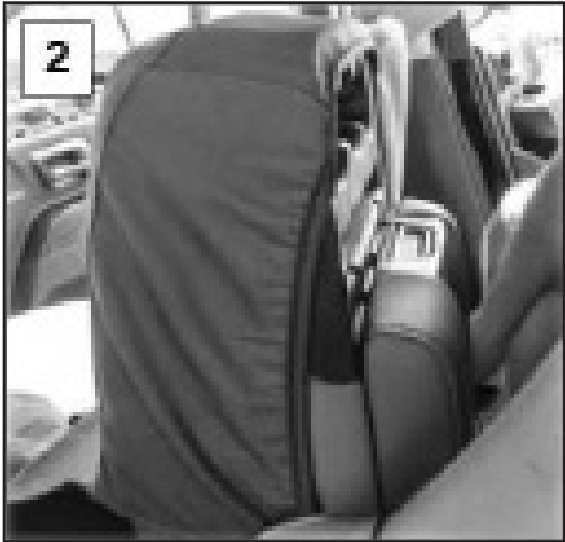
Deslice la cubierta sobre los portavasos del descansabrazos central
