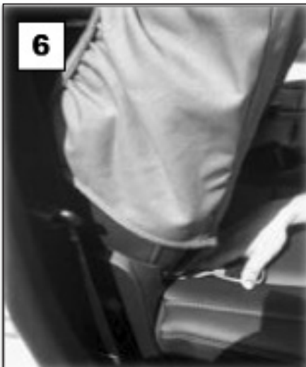
Fixer les bandes velcro à la housse de siège.
