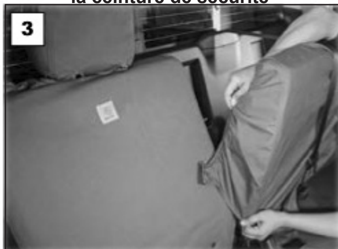
3 Placer la housse entre le dossier et la base du siège.
