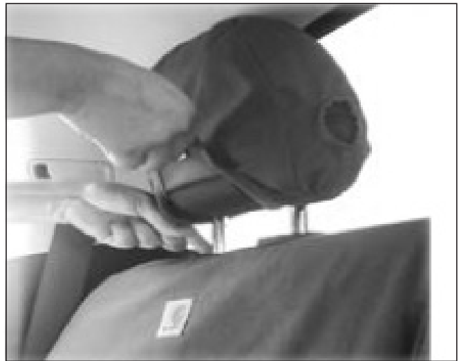
Fixer la bande velcro et vérifier le fonctionnement de l'appuie-tête.
