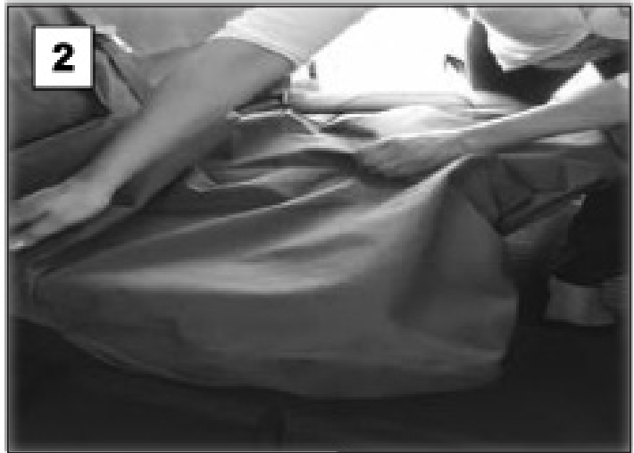
Coloque la cubierta y empuje la cubierta sobre el asiento
