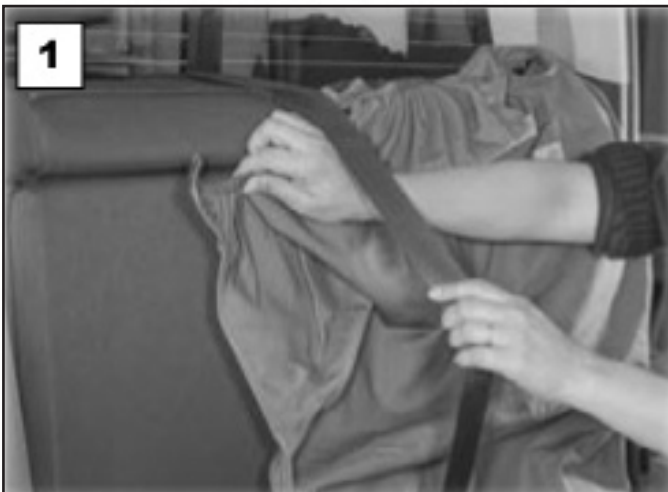
1 Coloque la cubierta debajo y alrededor del cinturón de seguridad
