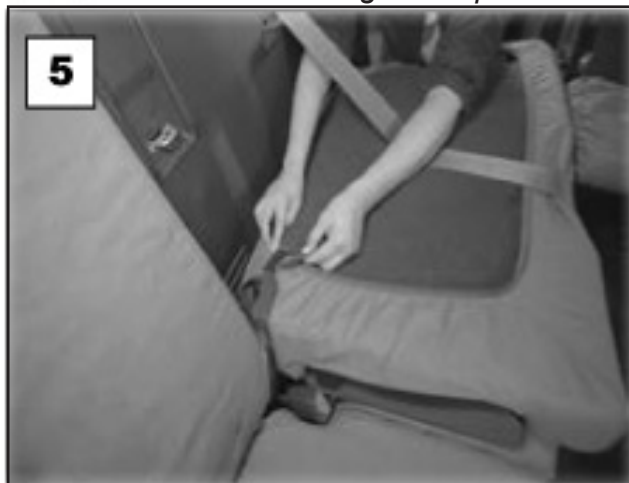
Coloque la cubierta entre el respaldo y el fondo
