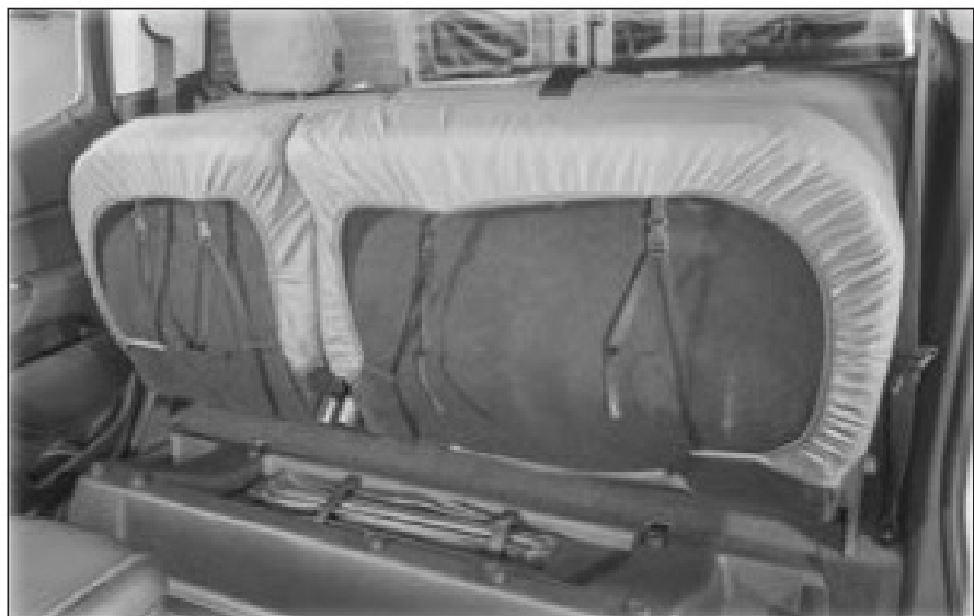
Empuje la cubierta entre el respaldo y el fondo para asegurar la cubierta
