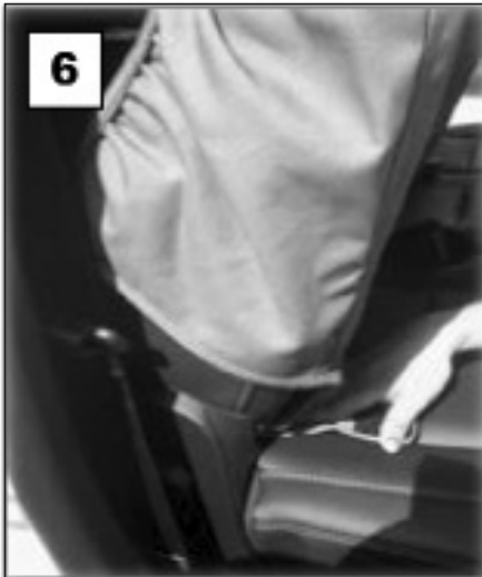
6 Conecte las correas de velcro a la cubierta del asiento
