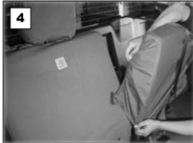
4 Placer la housse entre le dossier et la base du siège.
