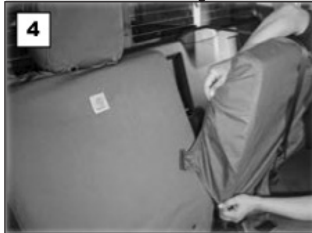
Coloque la cubierta entre el respaldo y el fondo
