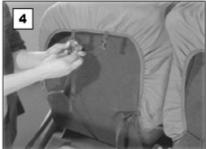
Empuje la cubierta entre el respaldo y el fondo para asegurar la cubierta
