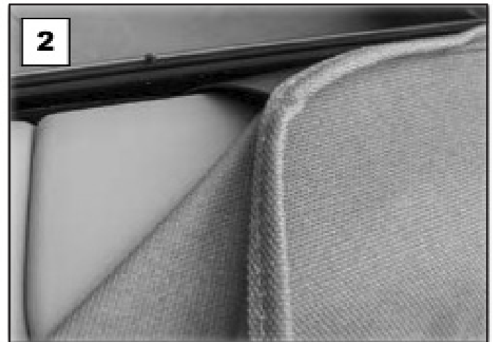
Glisser la languette en plastique entre la vitre et le joint d'étanchéité.
