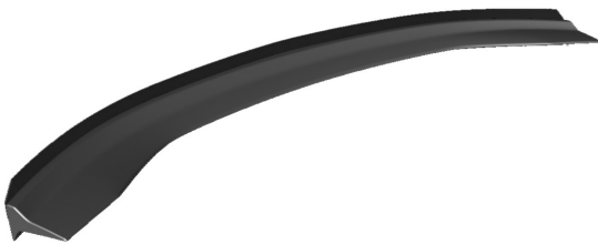
Figure 2 : vue isométrique avant de l'interface entre le becquet d'aileron et l'aileron.
