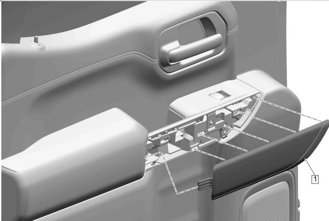
2. Placer le nouveau couvercle de garniture d'accoudoir de portière latérale arrière (1) vers l'extérieur et vers l'arrière pour engager le crochet intégré tout en tournant les clips de retenue pour les engager. Recommencer du côté opposé.
