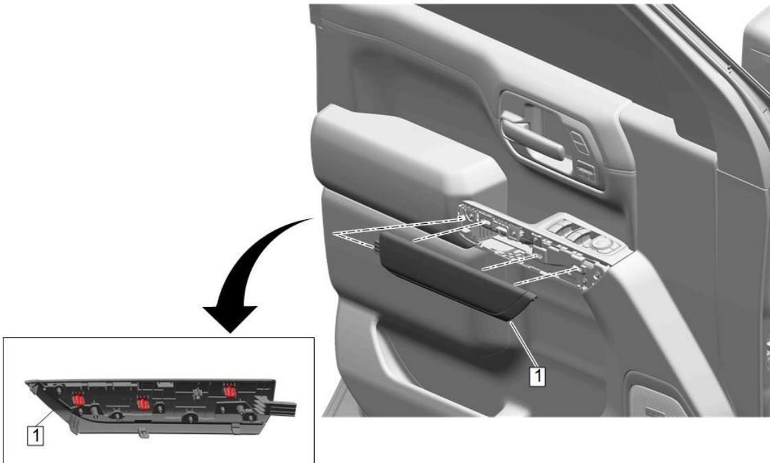
3. Placer le nouveau couvercle de garniture d'accoudoir de portière latérale avant (1) vers l'extérieur et vers l'arrière pour engager le crochet intégré tout en tournant les clips de retenue pour les engager. Recommencer du côté opposé.
