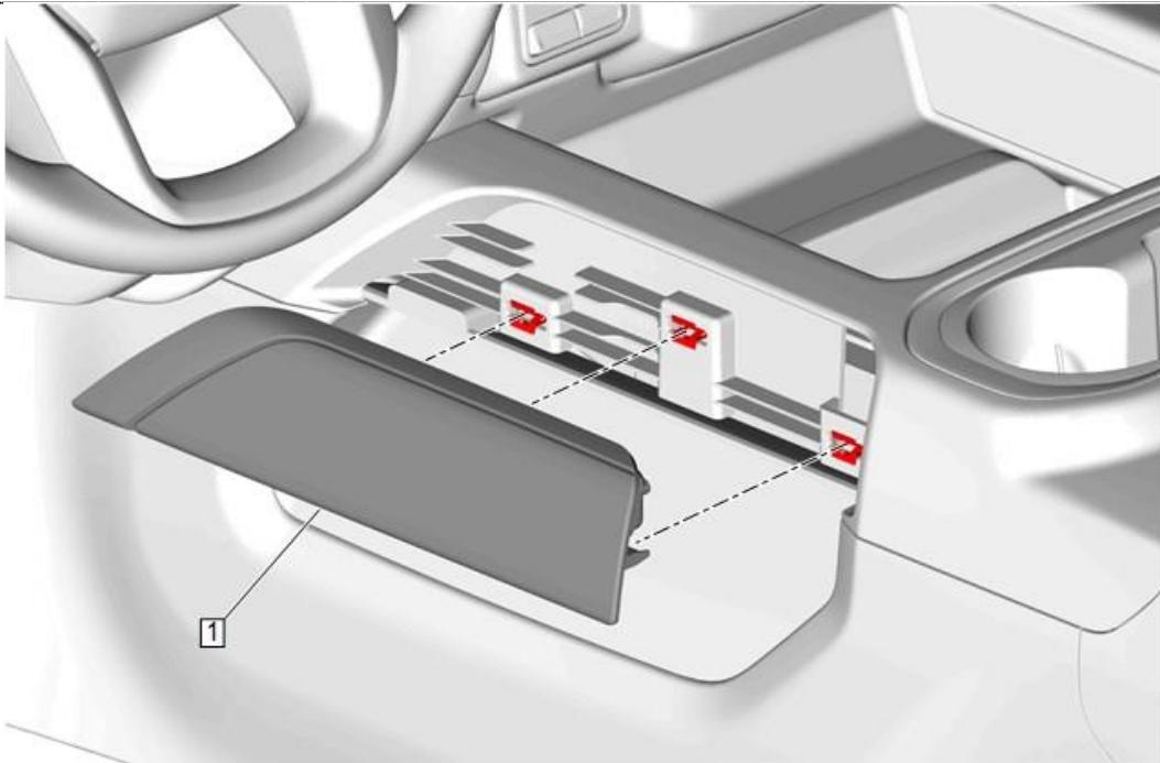
3. Utiliser un outil à garniture en plastique à lame plate pour dégager les clips de retenue et retirer l'applique de console de plancher avant (1), s'il y a lieu, de la console de plancher avant. Recommencer du côté opposé.
