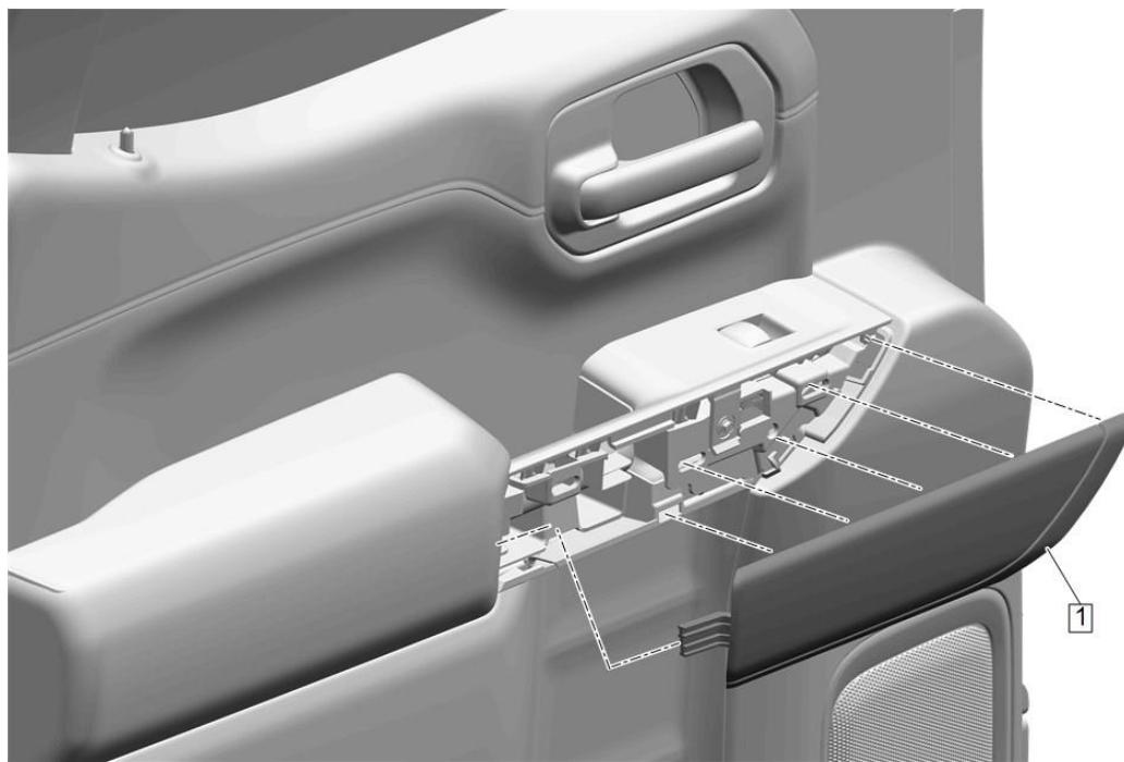
2. Commencer dans la partie supérieure avant et travailler vers l'arrière avec l'outil à garniture en plastique à lame plate pour décrocher le couvercle du panneau de garniture de portière arrière tout en tournant le couvercle de garniture d'accoudoir de portière latérale arrière (1) vers l'intérieur et vers l'avant pour le dégager du crochet intégré. Recommencer du côté opposé.
