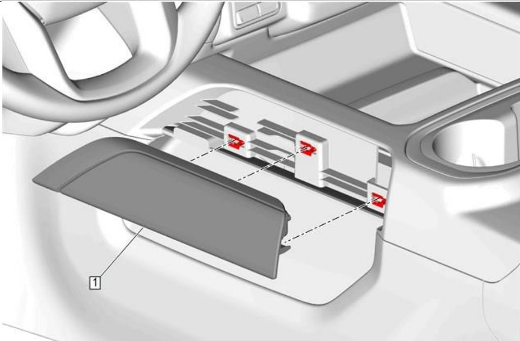
3. Con una herramienta de moldura de plástico de punta plana, libere los sujetadores de retención y retire la aplicación de la consola de piso delantera (1), si está equipado, de ésta. Repita para el lado opuesto.
