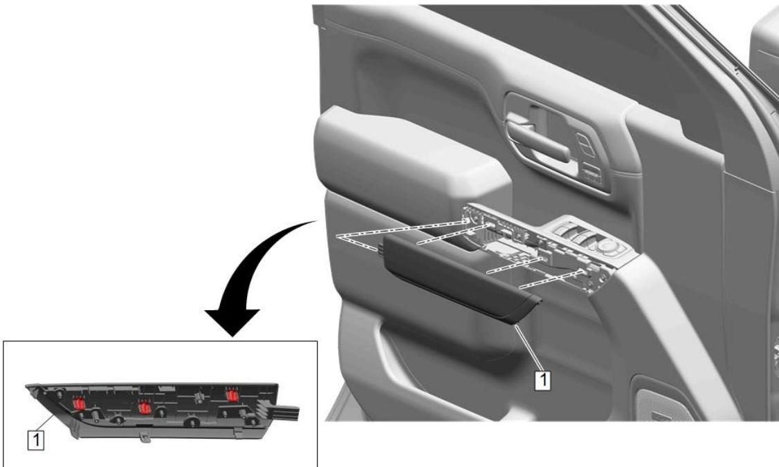
3. Coloque la nueva cubierta de moldura del descansabrazos de la puerta lateral delantera (1) hacia afuera y atrás para conectar el gancho integral mientras gira para conectar los sujetadores de retención. Repita para el lado opuesto.
