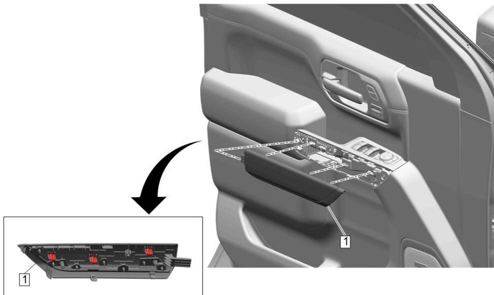
1. Utiliser un outil à garniture en plastique à lame plate pour séparer le couvercle de garniture d'accoudoir de portière avant (1) de la base, puis glisser le couvercle vers l'avant pour le décrocher du panneau de garniture de portière avant. Recommencer du côté opposé.
