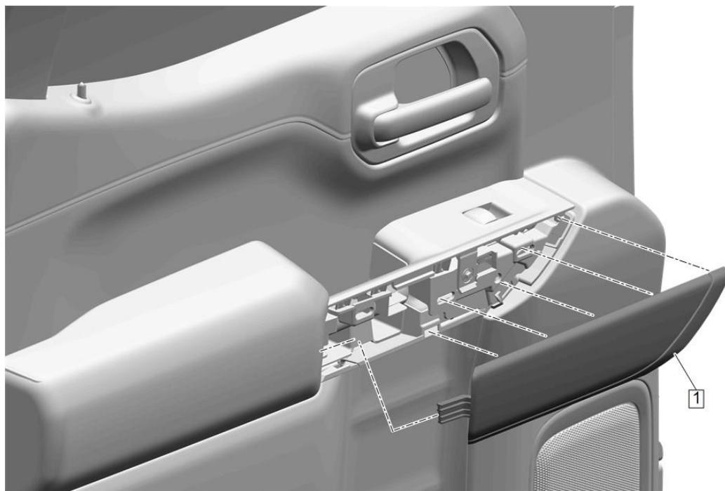
2. Comience en la parte superior delantera y continúe hacia atrás con la herramienta de moldura de plástico de punta plana para desconectar del tablero de moldura de la puerta trasera mientras gira la cubierta de moldura del descansabrazos de la puerta trasera (1) hacia adentro y hacia adelante para desconectar el gancho integral. Repita para el lado opuesto.
