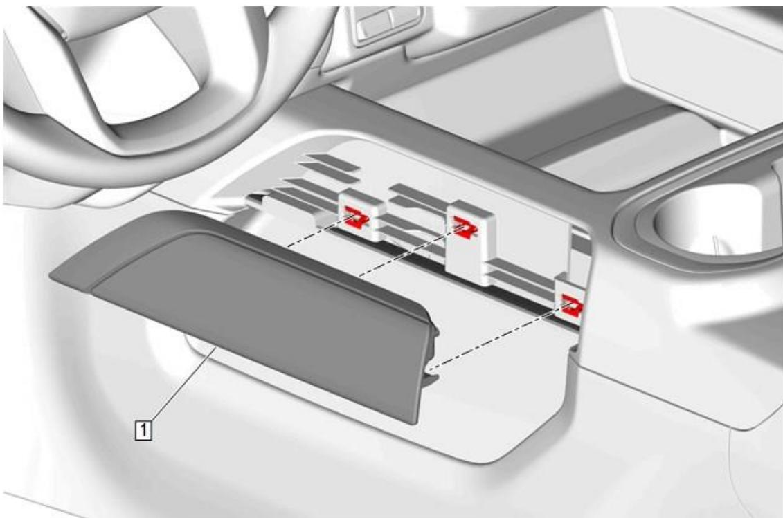
1. Coloque la nueva aplicación de la consola de piso delantera (1), si está equipado, a la consola de piso delantera asegurándose de conectar los sujetadores de retención. Repita para el lado opuesto.
