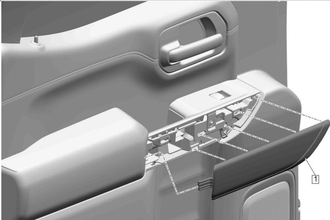
2. Coloque la nueva cubierta de moldura del descansabrazos de la puerta lateral trasera (1) hacia afuera y atrás para conectar el gancho integral mientras gira para conectar los sujetadores de retención. Repita para el lado opuesto.
