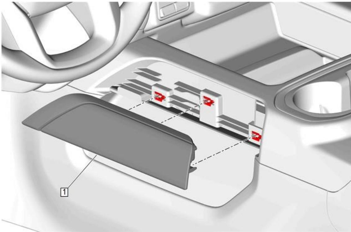
1. Placer l'applique de console de plancher avant (1) neuve, s'il y a lieu, sur la console de plancher avant en s'assurant d'engager les clips de retenue. Recommencer du côté opposé.
